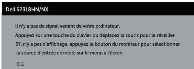
Si le câble VGA ou HDMI n'est pas branché, une boîte de dialogue flottante, indiquée ci-dessous, s'affichera. Le moniteur entrera en Mode d'économie d'énergie après 4 minutes s'il reste inutilisé.
